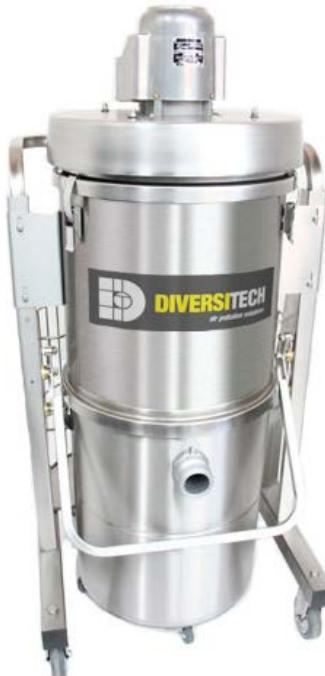
L'aspirateur à séparateur par bain d'immersion de liquide de Diversitech est conçu pour l'aspiration sûre des poussières et liquides explosibles et combustibles. Notre système de séparateur par immersion neutralise les poussières explosives, conductrices et combustibles en les immergeant dans un bain de liquide neutralisant pour les rendre inertes et éliminer les risques d'incendie ou d'explosion.
